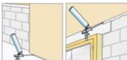
Obr. 10: Dopění odvětrávacích mezer PUR pěnou
